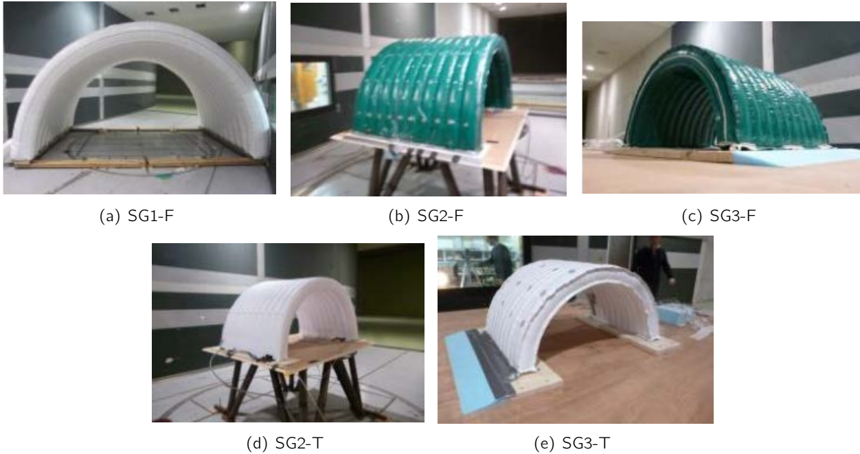
Fig. 4.21 – Panorama des maquettes fabriquées pour la recherche de similitudes par un essai en soufflerie.
