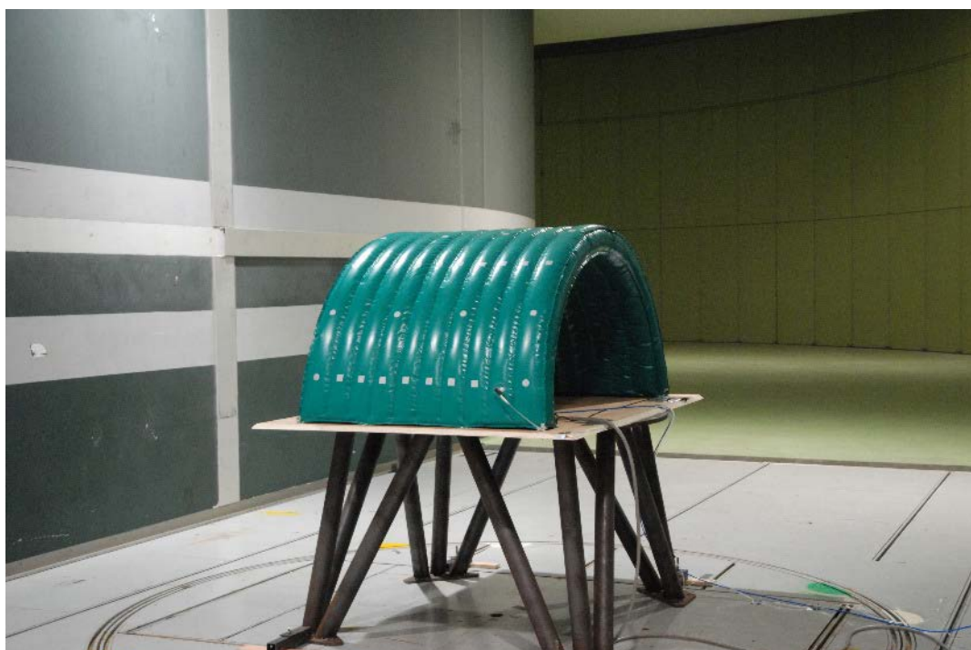
(b) Fixation d'une maquette de taille SG2 sur une table au centre de la veine
