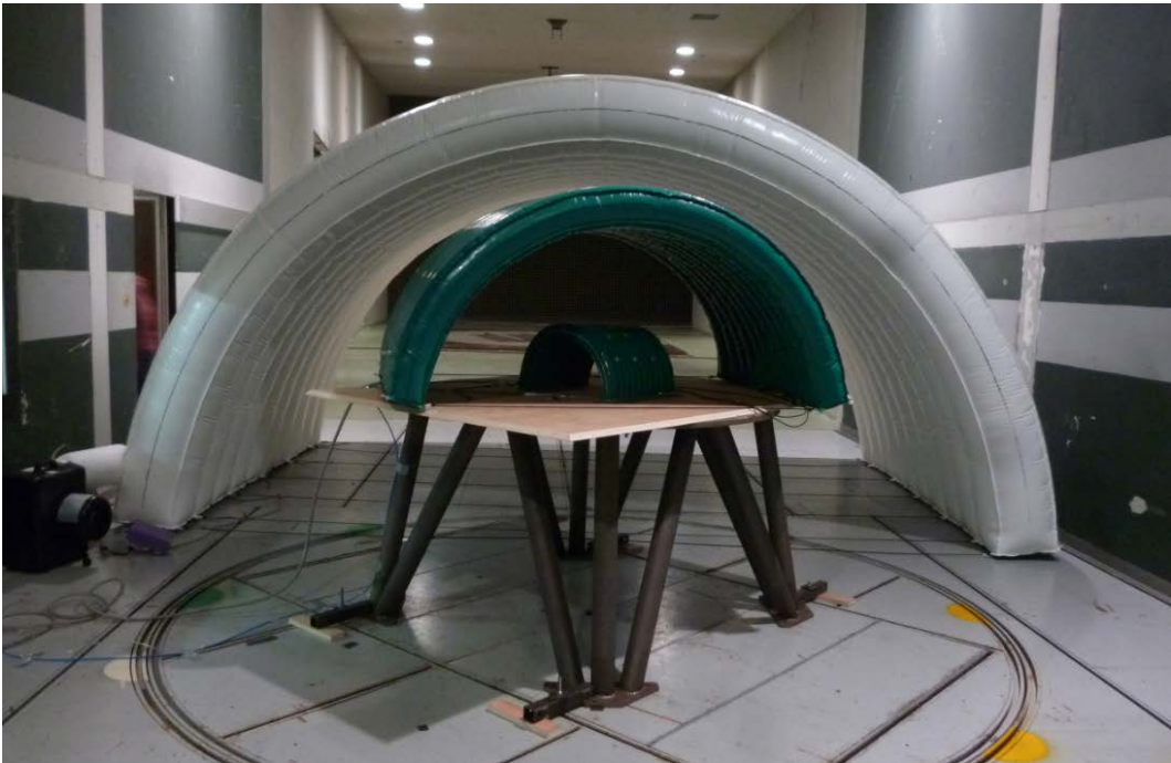
Fig. 4.20 – Présentation du bâtiment gonflable réalisé à 3 échelles différentes n = 1 , n = 1/3 et n = 1/9 fabriquées en tissu Ferrari F302.
