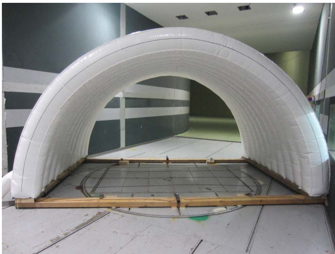
(a) Fixation de la maquette de taille SG1 sur son cadre
