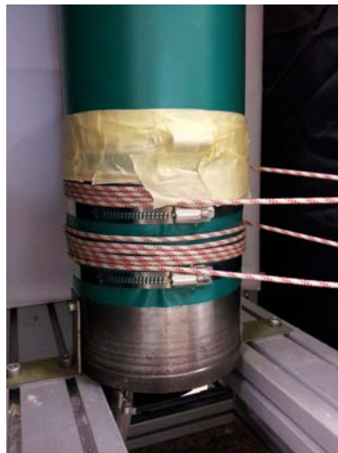
Fig. 3.22 – Visualisation de l'encastrement réalisé.
