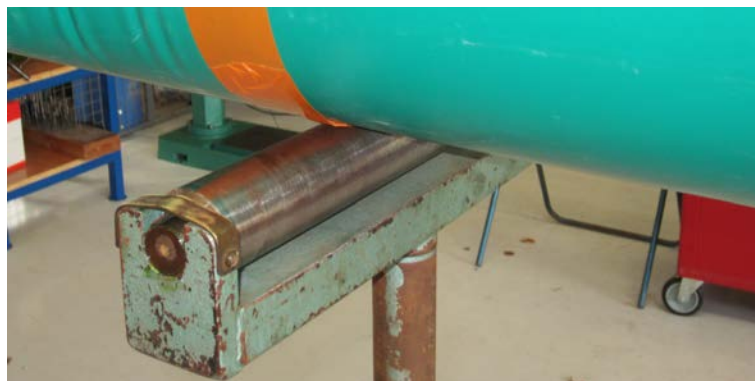
Fig. 2.44 – Réalisation des appuis à l'aide d'un rouleau en acier poli et dont l'axe est graissé.
