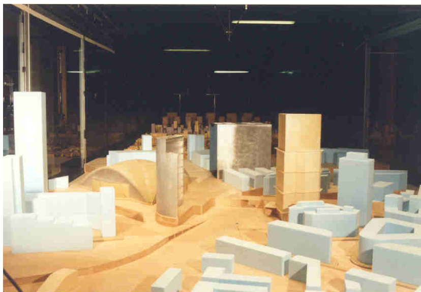
Aménagement intérieur de la veine de la soufflerie atmosphérique du CSTB Rugosité du type "centre de grande ville"
