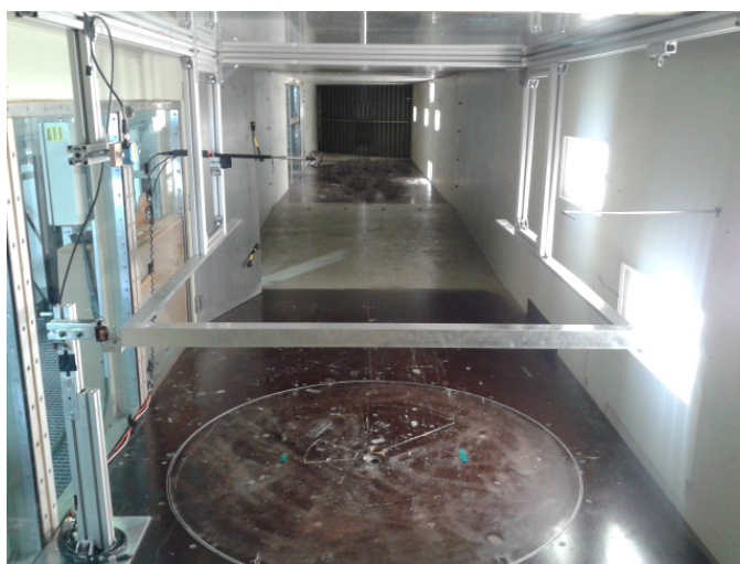
Fig. 1 : Système expérimental installé dans la veine d'essais de la soufflerie aérodynamique.
