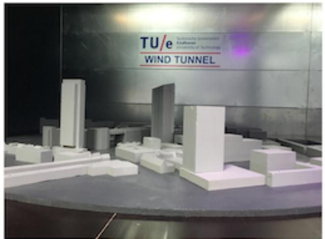
Fig. 5 : Anémomètre 3D de l'INRS déployé sur site et maquette de TU/e pour étude en soufflerie
