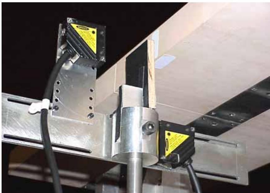
Figures 5.4, 5.5, 5.6 – Dispositif de mesure des déformées modales
